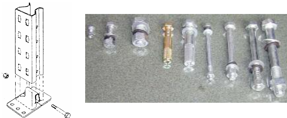
Figura 12: Prindere la bază tipică și șuruburi folosite la aceste prinderi (Godley 1991)
