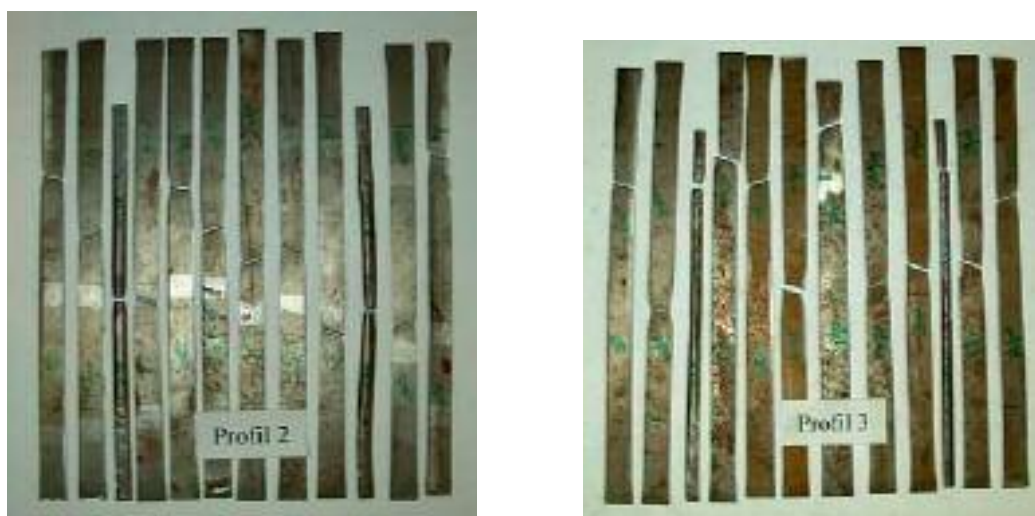
Figura 110: Fâșii decupate pentru determinarea modificării caracteristicii de material
