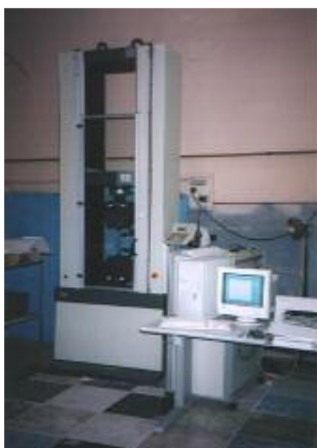
Figura 65: Mașina universală de încercări de materiale UTS 250kN
