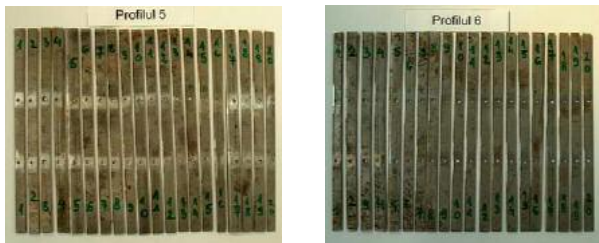
Figura 117: Profilul 5 și 6 decupate în fâșii pentru determinarea tensiunilor reziduale flexionale
