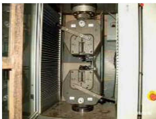
Figura 45: Presa pentru încercări la tracțiune
