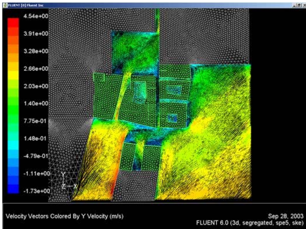
Figura 6: Vectori directie si viteza vantului rezultati in urma calculului numeric
