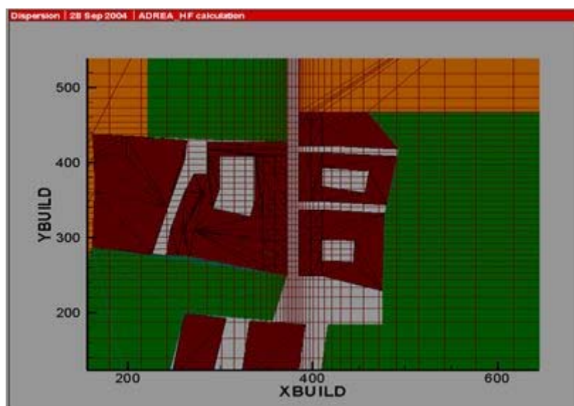
Figura 5. Rețeaua ortogonală folosită pentru discretizarea geometriei (Adrea Hf)
