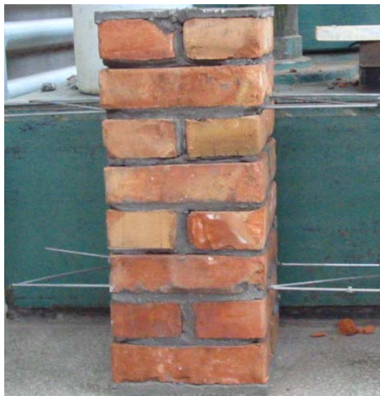
Foto 3.16 – Stâlpișor de zidărie armată înainte de încercare
