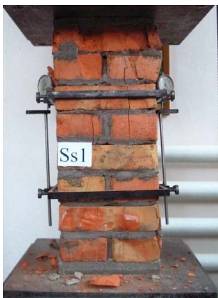
Foto 3.17 – Ruperea unui stâlpișor de zidărie simplă
