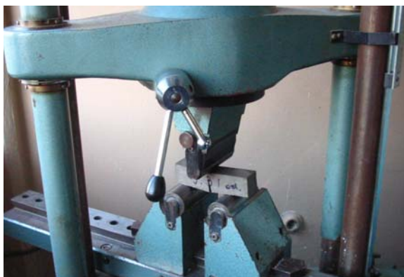
Foto 3.19 – Determinarea rezistenței la întindere a mortarului
