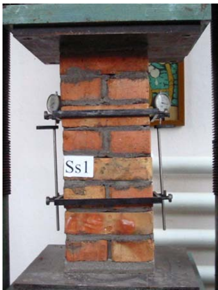
Foto 3.15 – Stâlpișor de zidărie simplă cu juguri și microcomparatoare pregătit pentru încercare
