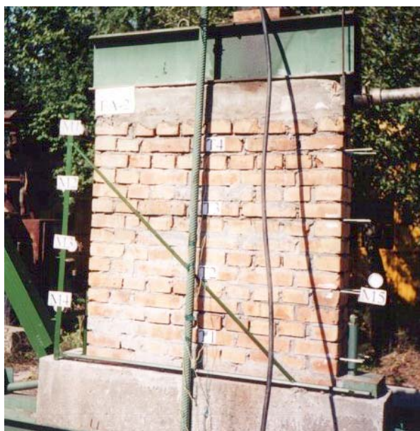
Foto 3.8 – Elementul EA2 pregătit pentru încercare
