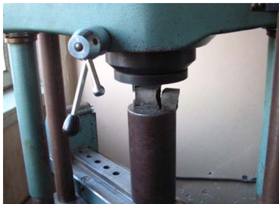
Foto 3.20 – Determinarea rezistenței la compresiune a mortarului
