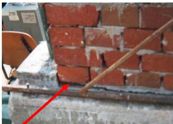
Foto 3.6 – Ruperea din compresiune excentrică la P=12000daN
