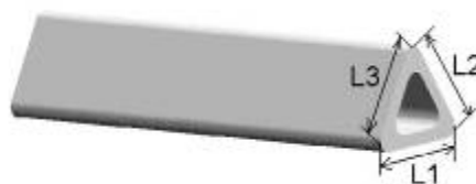
Fig.6 Forma aproximativă a probei pentru încercările de tracțiune și încovoiere
