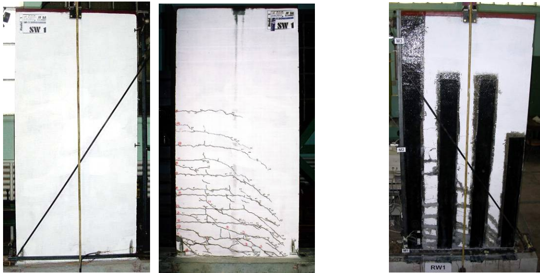
a) Peretele SW1 înainte și după încercare.
