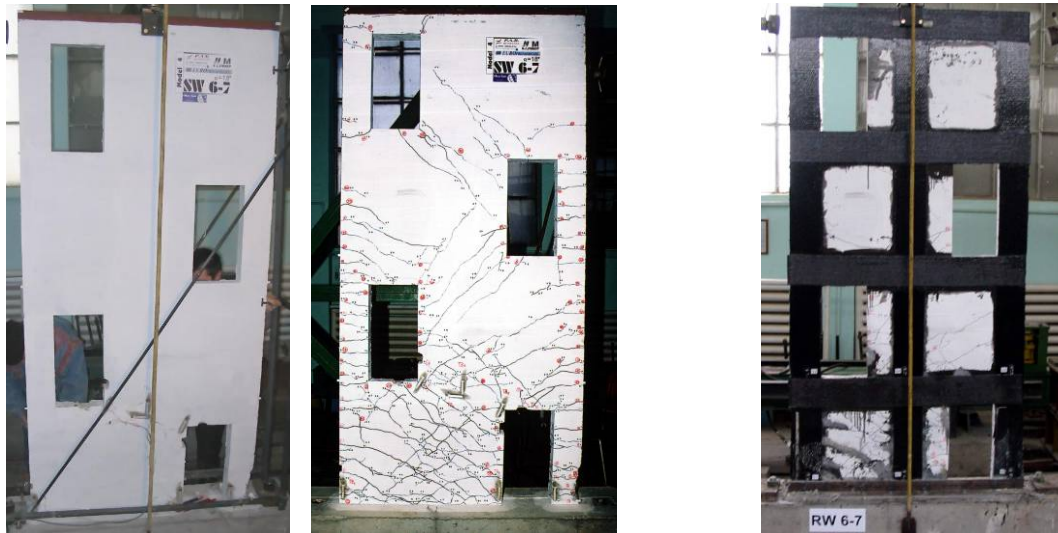
a) Peretele SW67 înainte și după încercare.
