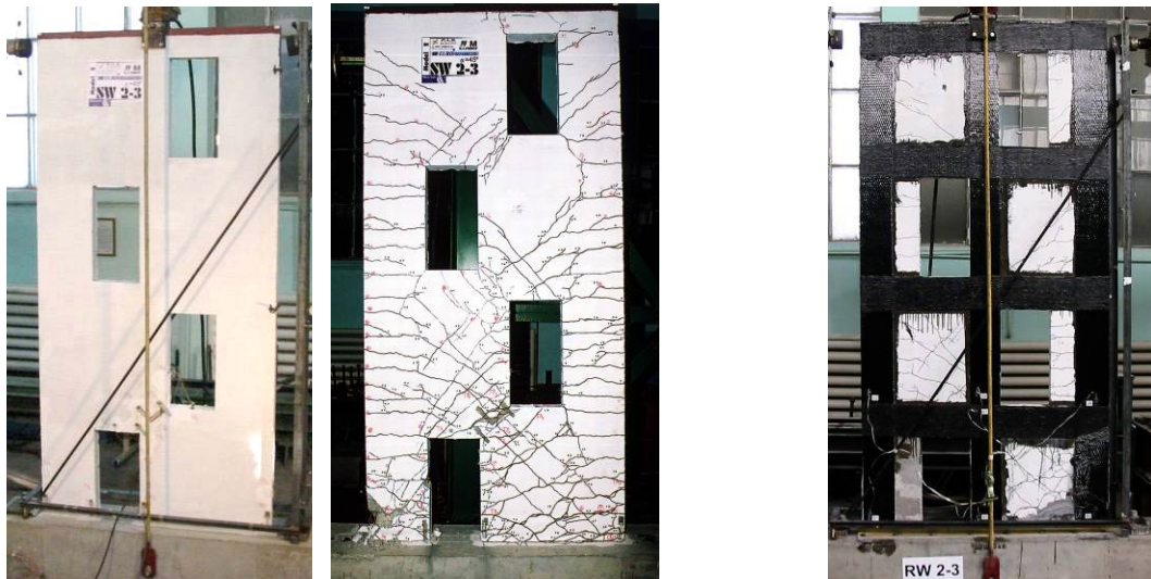
a) Peretele SW23 înainte și după încercare.
