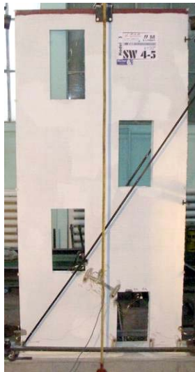
a) Peretele SW45 înainte și după încercare.
