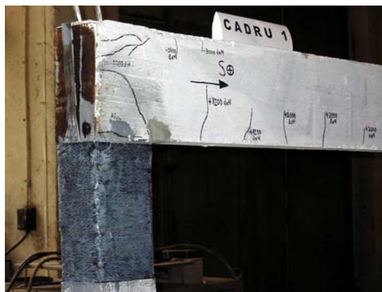
Figura 7. Desprinderea lamelelor verticale CFRP datorită eforturilor de întindere
