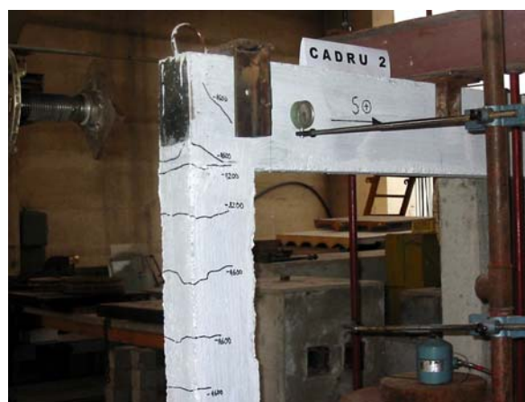
Figura 5. Modul de cedare a cadrelor din beton armat
